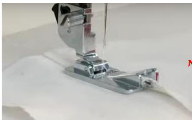
Ce pied réalise des coutures rabattues parfaites et durables sur tissus moyennement épais à épais. Le tissu est plié proprement grâce au guide en une seule pression. Plus besoin de repasser le pli au préalable
