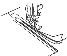
Ce pied peut s'employer pour coudre avec précision des deux côtés de la fermeture à glissière en alignant la position du pied (tournez la vis pour régler la distance). Également pour coudre très près d'un passepoil ou d'un cordon.
