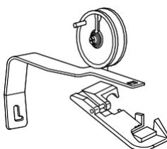
Ce pied pour ruban avec roulette (roue) est très utile pour façonner des vêtements en tricot ou en stretch. La roulette guide le biais pendant la couture évitant ainsi qu'il ne gondole.
