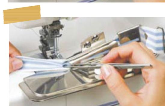
Tirez l'extrémité du biais à l'aide de la pincette sous le guide. Faites passer le biais vers l'arrière du pied de biche. Faites attention que le biais soit correctement formé dans le guide et passe bien plié entre le dessus et le dessous.
