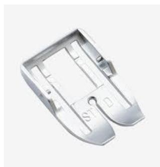
Ce pied est utilisé pour des tissus très fins ou très lourds. Le pied étant plat en dessous, il fournit une pression uniforme sur les griffes d'entraînement. Evite également les points sautés et le fronçage du tissu.
