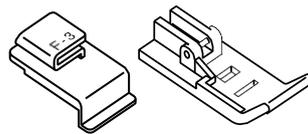
Coudre une dentelle ou un ruban parfaitement aligné sur le tissu avec le point couvert. Utilisez avec ce guide le pied chaînette transparent (F).
