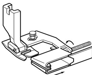
Employez ce pied pour poser un biais sur des bords inachevés. Alignez la position de l'aiguille avec la vis de réglage. Guidez le tissu avec la main gauche et le biais avec la main droite.
