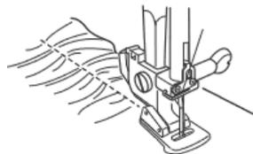
Comme son nom l'indique, il permet de créer de petites fronces ou de poser un volant. Le dessous du pied de biche est plus haut derrière l'aiguille. On passe le tissu dans le pied et à la couture, cela forme de jolies fronces. Pour des fronces plus importantes, il est conseillé d'utiliser l'appareil à plisser (ou ruffer)
