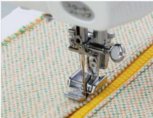
Il vous permettra de poser des fermetures à glissière. (Couture à droite et à gauche de la fermeture)
