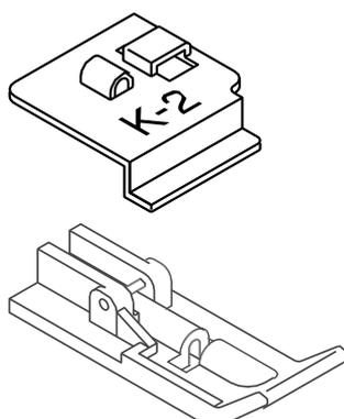
Créez des nervures où une cordelette fine est mise sous la nervure. Enfilez la cordelette par le trou du guide et passez-le sous le tissu. Employez ici alors ce guide en combinaison avec le pied à nervures.
