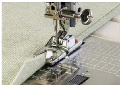
Ces pieds permettent de réaliser des ourlets fins de 2 – 4 ou 6mm selon les pieds. Le tissu est entrainé dans « l'entonnoir » du pied de manière à créer le roulotté automatiquement
