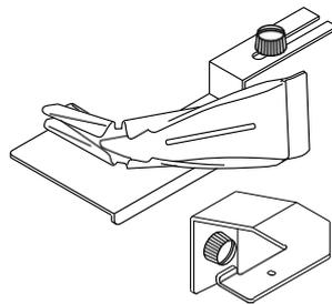
Le guide se clique à l'avant de la machine. Coupez des bandes droites de tissu de 40mm de large pour les coudre après le long de la ligne d'encolure par exemple d'un T-shirt.
