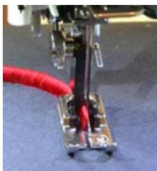
Ce pied est doté d'un diviseur au centre de sorte qu'à la couture en point zigzag large, une boucle se crée. Il suffit de la découper au centre pour créer des franges.
