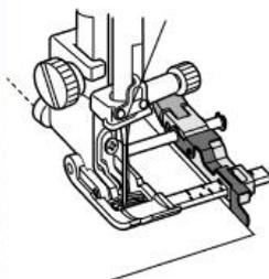
Vous pourrez régler facilement le guide jusque 2.5 cm (maximum) et réaliser des coutures parfaitement parallèles au bord du tissu. Les marques sont clairement indiquées sur le pied et le guide se règle en soulevant le levier à l'arrière du pied.
