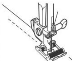
Comme indiqué il possède un rouleau en avant permettant de passer facilement les épaisseurs. Il passe sur des épaisseurs variables. Il est utilisé également sur le cuir et le vinyle
