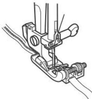
Ce pied est conçu avec des guides à travers lesquels on peut insérer des rubans ou des paillettes sur corde, ce qui leur permet de passer uniformément lors de la couture. En plus d'apposer des rubans, une variété de points d'échelle peuvent être utilisés avec un ruban étroit pour faire une coulisse de serrage facile et fonctionnelle.
