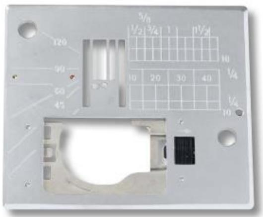
Cette plaque permet de coudre au point droit uniquement. On l'utilise notamment pour coudre des tissus très fins. Comparée aux plaques zigzag avec une large ouverture au niveau du passage de l'aiguille, cette plaque possède un passage plus étroit (évite les risques que le tissu ne se prenne dans les griffes de la machine)
