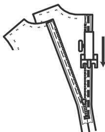
Ce pied peut s'employer pour placer une fermeture invisible. Les rainures à l'envers du pied déplient les dents de la fermeture pour les tenir sur place pendant la couture.
