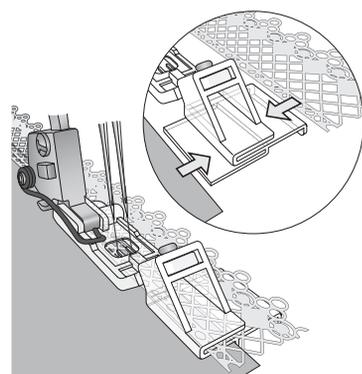
Astuce : Si vous souhaitez avoir une bordure de tissu finie, repassez un ourlet de 6 mm (1/4") sur le côté droit du tissu avant de l'insérer dans le pied pour bordure plate. La dentelle couvrira le bord brut du tissu une fois cousue.
