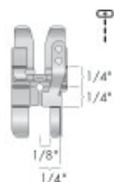
Le pied guide-bord 1/4" avec système IDT™ convient aux coutures d'assemblage d'1/4". Il vous suffit de suivre le guide avec votre bord de tissu. La distance entre l'aiguille et le guide-droit est d'1/4". Le pied guide-bord 1/4" réalise également de parfaites surpiqûres à distance régulière des bordures de blocs lorsque vous quiltez toutes les épaisseurs de votre quilt.
