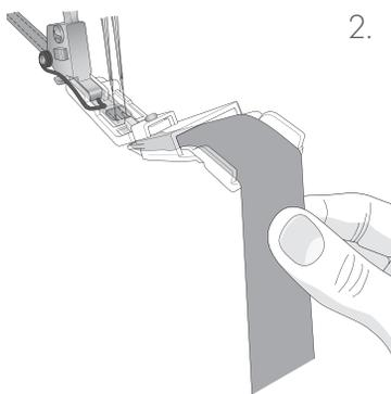
Avec le pied confection bride et passant de ceinture, créez facilement des brides et des passants de ceinture avec un point de recouvrement. Placez simplement une bande de biais dans le pied et elle sera automatiquement pliée et cousue.
