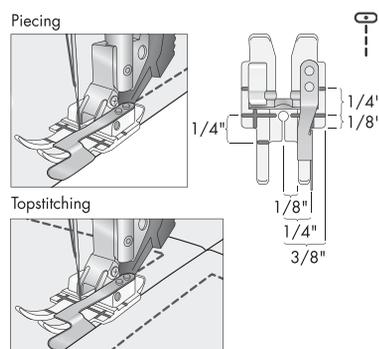
Le pied guide droit transparent 1/4 de pouce est conçu pour vous aider à réaliser des coutures pièces de 1/4 de pouce parfaites. Il vous suffit de guider le bord du tissu près du guide. Le pied transparent donne une superbe visibilité lorsque vous cousez. La distance entre l'aiguille et le guide droit est 1/4 de pouce.
