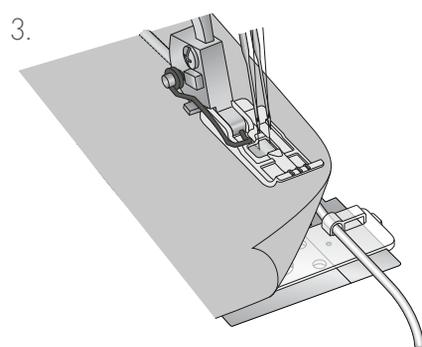
Obtenez un effet trapunto lorsqu'un point de recouvrement est cousu sur un cordonnet dans le guide.
