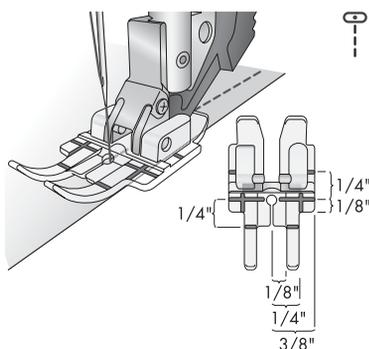
Le pied pour quilting transparent 1/4 de pouce est parfait pour assembler les morceaux de tissu, car il garantit une excellente visibilité lorsque vous cousez des coutures de 1/4, 1/8 et 3/8 de pouce. Les lignes rouges du pied presseur marquent les points de pivotement de 1/4" à l'avant et 820883-096 D E G J avec système IDT™ à l'arrière de l'aiguille.
