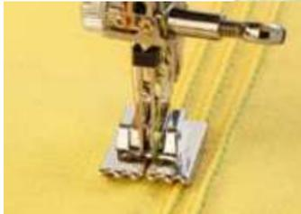
Employez le pied à nervures en combinaison avec le guide à cordes pour créer des rangées de nervures. Les rainures à l'envers du pied de biche vous guideront parfaitement le long des nervures déjà cousues et respecteront des distances égales choisies pour les suivantes.
