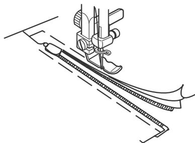
Ce pied peut s'employer pour coudre avec précision étroitement des deux côtés de la fermeture éclair en alignant la position du pied en tournant la vis. Egalement à employer pour coudre très près d'un passepoil ou d'une bande avec corde.
