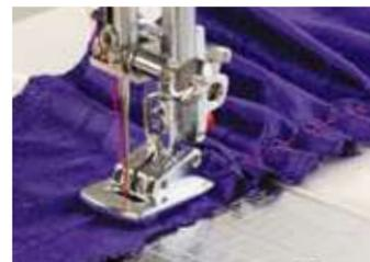
S'emploie pour froncer simplement et rapidement des bandes de tissu. La grandeur des fronces sera déterminée par le poids du tissu, la longueur des points et la tension du fil.
