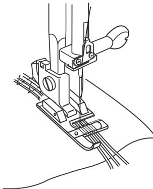
Le pied cordon peut tenir une, deux ou trois fines cordelettes ou fils de cordonnet. Grâce au pied, qui retient les cordelettes ou les fils de garniture sur place le projet choisi peut être suivi facilement. Une grande variété de points utiles ou décoratifs s'emploie pour fixer les cordelettes sur un tissu. Expérimentez pour des effets différents avec diverses sortes de fil et de couleurs. Le choix des cordes, du fil et du point choisi sont les facteurs, qui détermineront l'effet final.
