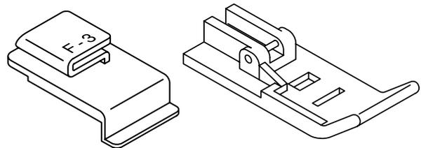
Coudre une dentelle ou un ruban parfaitement aligné sur le tissu avec le point couvert. Utilisez avec ce guide le pied chaînette transparent (F).
