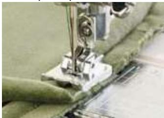
Ce pied sert à réaliser et à appliquer des bandes de passepoil. La rainure en dessous du pied de biche guide la corde. Ce pied sert également pour fixer un passepoil tout fait dans une couture.
