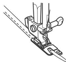
Le pied pour roulotté s'emploie pour la couture d'ourlet étroit, appliquée le plus souvent sur des chemises, des nappes et le long du bord de volants et fichus. Plier le tissu au départ et passez le dans le pied, dans la forme d'un rouleau, après dans la rainure à l'envers du pied, qui détermine la largeur de l'ourlet roulotté. Le pied pour roulotté de 4mm et de 6 mm peut servir également pour des tissus plus lourds.
