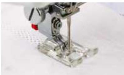
De par la forme spéciale de l'aiguille les trames du tissu, tissé lâchement tel que le coton et le lin, seront écartées d'où apparaissent des petites ouvertures. Choisissez pour un meilleur résultat des points de fantaisie où l'aiguille passe plusieurs fois dans le même trou.
