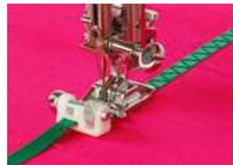
Pour fixer des rubans et des paillettes d'une manière facile. Placer le ruban de paillettes dans l'ouverture du guide et tirer un petit morceau du ruban à paillettes plus loin que l'arrière du pied.
