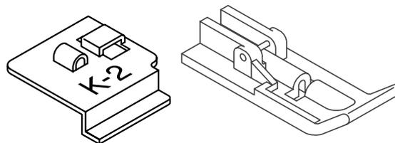
Créez des nervures où une cordelette fine est mise sous la nervure. Enfilez la cordelette par le trou du guide et passez-le sous le tissu. Employez ici alors ce guide en combinaison avec le pied à nervures.
