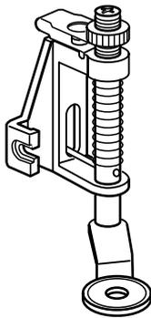
Le pied à repriser avec ressort peut s'employer pour le quilting et la broderie de main libre et pour réaliser des monogrammes. La plaque se place sur la plaque aiguille de la machine pour cacher le transporteur.
