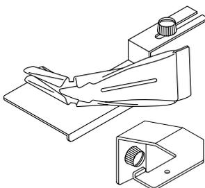
Le guide se clique à l'avant de la machine. Coupez des bandes droites en tissu de 40mm de large pour les coudre après le long de la ligne d'encolure par exemple d'un T-shirt.
