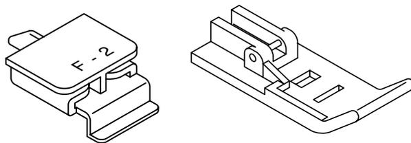
Les techniques faux jours ressemble à de la fine dentelle qui s'applique sous et entre deux morceaux de tissu. Ce guide tient les deux morceaux de tissu séparés à distance égale. Pour un résultat encore plus décoratif vous pouvez utiliser un fil de garniture.
