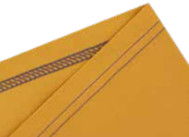
Point de recouvrement 3 fils pour tous types de finitions d'ourlets
