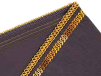
Point expressif à 7 fils point de recouvrement trois aiguilles combiné au surjet 3 fils étroit
