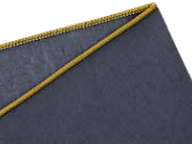
Roulotté à 3 fils couture de surjet étroite pour les tissus fins
