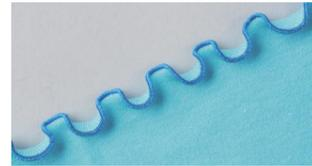
**3-fils roulotté avec ajustement différentiel**
