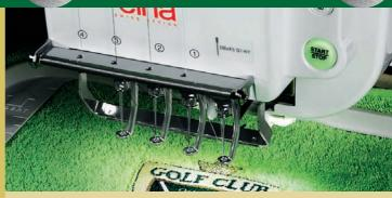
Une machine totalement autonome! Changement de couleurs automatique grâce aux 4 aiguilles.
