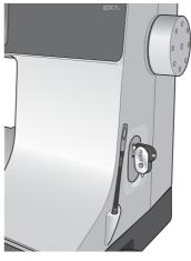
Remarque: la clé USB Embroidery Stick fournie avec la machine peut être laissée dans la machine lorsque vous remettez le capot. Assurez-vous que le couvercle de la clé USB est tourné vers le bas.
