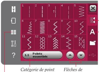
Catégorie de point Flèches de Menu de sélection défilement
