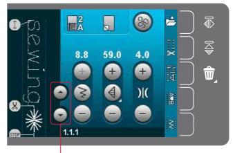
Flèches (pour déplacer le curseur vers l'avant et vers l'arrière dans la séquence)
