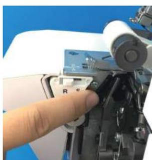
Montage : insérer la nouvelle lame inférieure, serrer la vis de retenue, remettre la lame supérieure en position de travail, fermer le capot du crochet.
