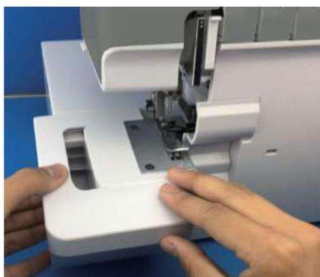
Retirer le réceptacle pour chutes, retirer la table vers la gauche et remettre le réceptacle pour chutes en place.
