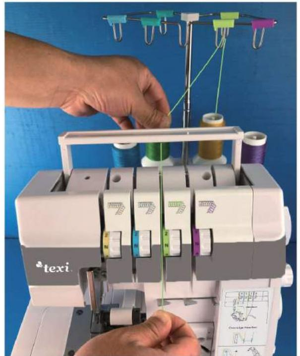
Soulevez la poignée, guidez le fil à travers le disque tendeur et tirez vers le bas, le fil sera tendu par le disque. Remettre la poignée en place.
