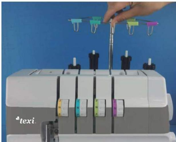
Levez le support des fils à la plus haute position jusqu'au clic. Placer les bobines de fils sur les supports et faire passer les fils par les guidages sur le support de l'arrière vers l'avant.
