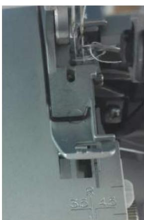
Retirer le récipient à découper et tourner le bouton de réglage de la largeur de couture (réglé sur 3,0-4,5 mm).
