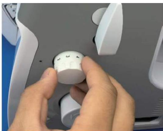
En tournant le bouton de réglage de point, on peut régler la plage de F (1 mm) à 4 mm. Pour la couture ordinaire, la longueur de point est fixée à 3 mm, et pour les tissus plus épais à 4 mm.
