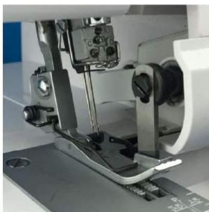
La machine dispose de quatre positions d'aiguille différentes. Deux aiguilles peuvent être utilisées en même temps. La vis de fixation A est pour l'aiguille droite. La vis de fixation B est pour l'aiguille gauche.
