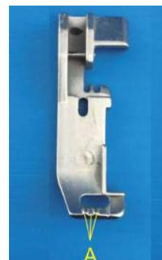
Abaissez le support du pied-de-biche pour verrouiller le pied dans sa position. Comme le montre la figure, la graduation sur le pied (A sur la photo) indique l'amplitude du mouvement de l'aiguille. Cela peut être utile dans le processus de couture.
