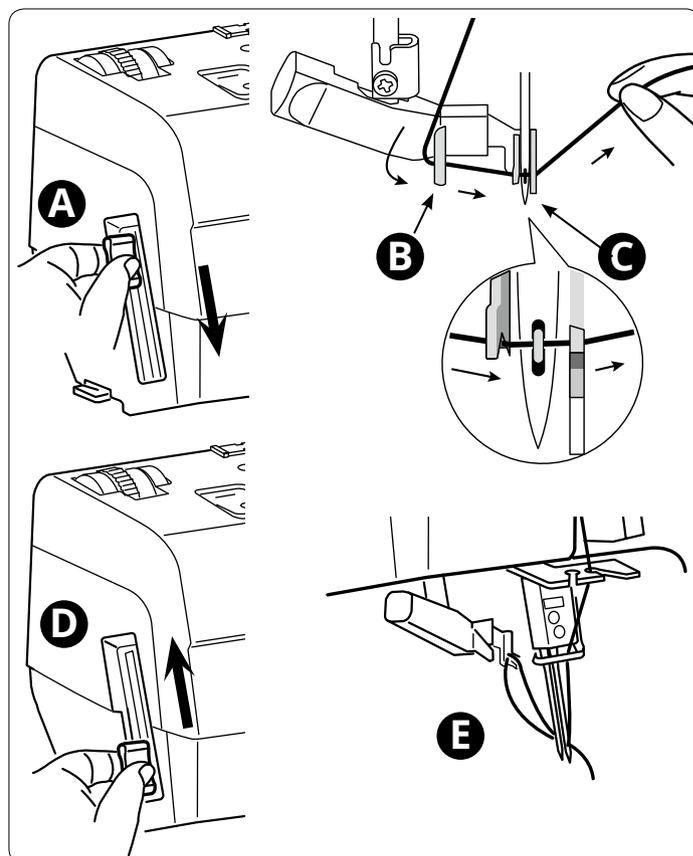
Abaissez doucement le levier de l'enfile-aiguille (D), afin qu'une boucle de fil soit introduite dans l'aiguille (E).
