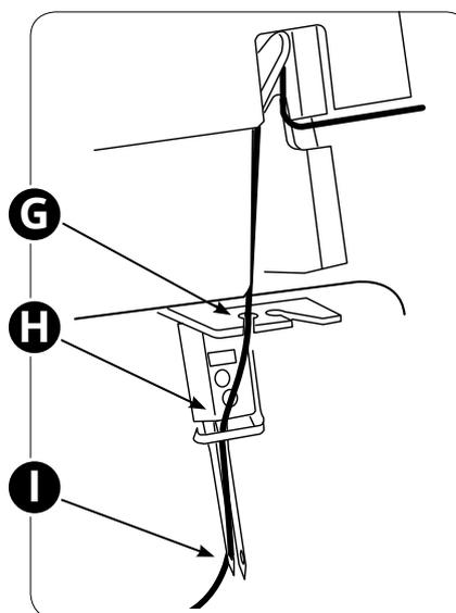
Faites ressortir de l'aiguille environ 10 cm (4") de fil et insérez-le sous le pied, afin qu'il passe entre le pied et le couteau supérieur.
