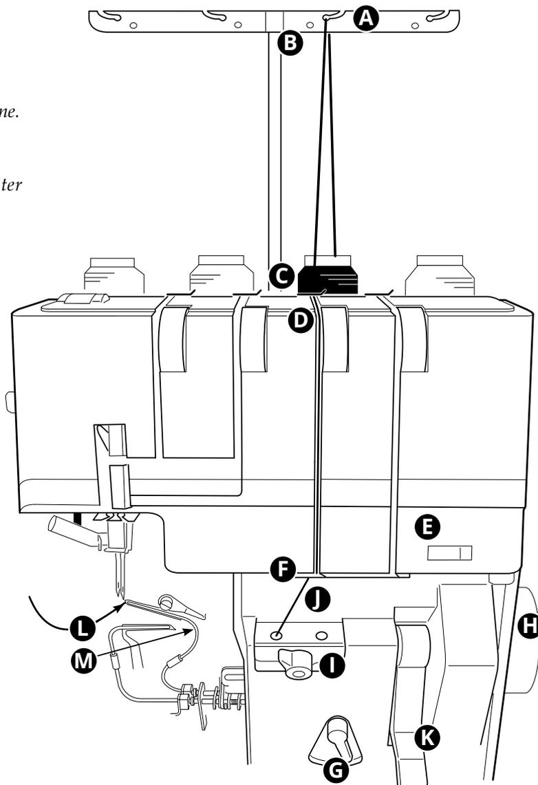
Placez une bobine de fil sur la deuxième broche porte-bobine en partant de la droite. Tirez le fil à travers le deuxième guide-fil en partant de la droite, de l'arrière vers l'avant (A).
