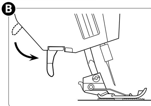
Réglez l'interrupteur d'enfile-aiguille sur « R » pour enfileur l'aiguille de droite.
