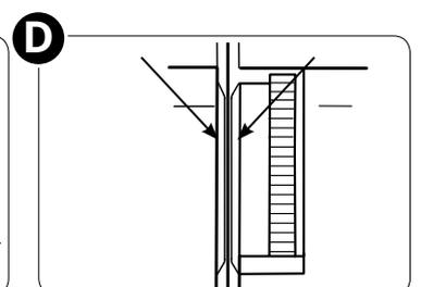
Faites descendre le fil le long de la fente et passez-le à gauche à travers le chemin de fil (E).
