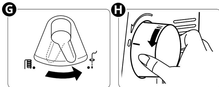
Faites tourner le levier de sélection de boucleur vers la gauche (I) pour activer l'enfilage du boucleur supérieur.
