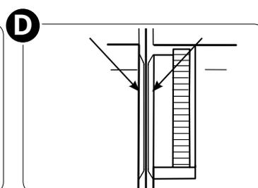
Faites descendre le fil le long de la fente et passez-le à gauche à travers le chemin de fil (E).
