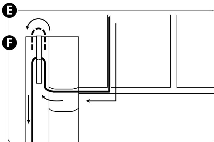
Passez le fil à travers la fente de gauche du guide-fil d'aiguille (G).
