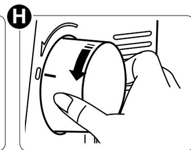
Faites tourner le levier de sélection de boucleur vers la droite (I) pour activer l'enfilage du boucleur inférieur.
