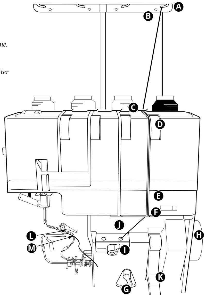
Placez une bobine de fil sur la broche porte-bobine la plus à droite. Tirez le fil à travers le guide-fil de droite, de l'arrière vers l'avant (A).
