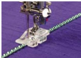
D'une facilité étonnante pour fixer un ruban de perles! Sélectionner un point zigzag et modifier la longueur et la largeur pour s'assurer que le point se fait par-dessus les perles.
