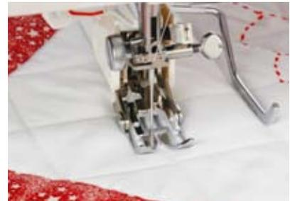
Le pied double transport transporte souplement la couche supérieure du tissu de la même façon que la couche inférieure. De cette façon la couture ne présente ni tiraillements ni fronces, car les deux tissus superposés sont pris ensemble par le transport supérieur et inférieur. Employez-le guide couture pour la réalisation de coutures parallèles parfaitement alignées.
