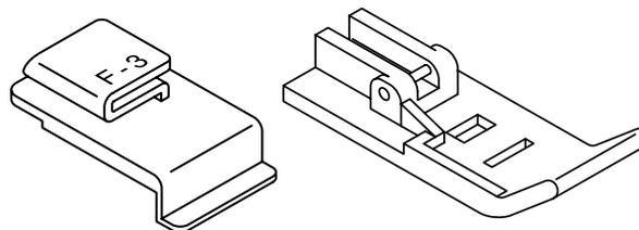
Coudre une dentelle ou un ruban parfaitement aligné sur le tissu avec le point couvert. Utilisez avec ce guide le pied chaînette transparent (F).
