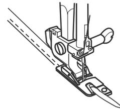
Le pied pour roulotté s'emploie pour la couture d'ourlet étroit, appliquée le plus souvent sur des chemises, des nappes et le long du bord de volants et fichus. Plier le tissu au départ et passez le dans le pied, dans la forme d'un rouleau, après dans la rainure à l'envers du pied, qui détermine la largeur de l'ourlet roulotté. Le pied pour roulotté de 4mm et de 6 mm peut servir également pour des tissus plus lourds.
