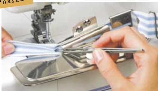
Tirez l'extrémité du biais à l'aide de la pincette sous le guide. Faites passer le biais vers l'arrière du pied de biche. Faites attention que le biais soit correctement formé dans le guide et passe bien plié entre le dessus et le dessous.
