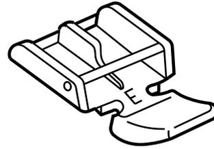
Ce pied peut se placer de tel façon que les deux côtés de la fermeture éclair peuvent se coudre. Le bord du pied tirette conduit la fermeture éclair pour garantir un placement correct.
