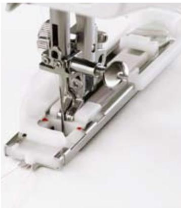
Employer pour des tissus fins également des fils et des aiguilles plus fins. Ajouter une cordelette pour les renforcer. Accrocher une fine cordelette à l'ergot à l'arrière du pied, faire revenir la cordelette vers l'avant jusque devant la fourchette avant de commencer la couture de la boutonnière.
