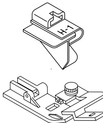
Efficient et malin, ce guide plie parfaitement une largeur de 6mm. En même temps que de réaliser l'ourlet vous pourriez fixer une dentelle ou un ruban. Utilisez avec ce guide le pied ourlet couvert(M).
