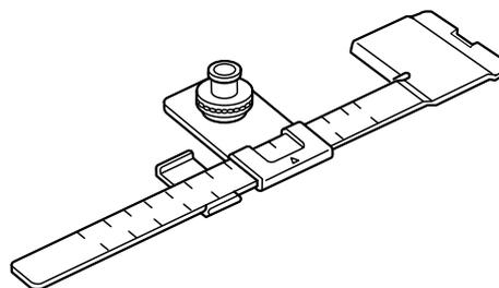
L'appareil circulaire est un instrument idéal pour coudre des cercles, en employant éventuellement un point droit, un point zigzag, un point décoratif ou même des lettres. Des cercles avec un diamètre maximal de 26 cm seront cousus parfaitement grâce à cet aide populaire et qui est essentiel pour la décoration de vos projets.
