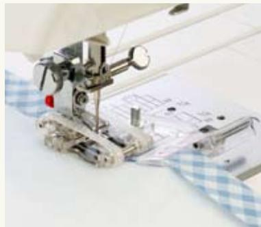
L'accessoire pour biais est réglable et vous permet de finir un tissu avec un biais préformé jusque 20 mm de largeur.
