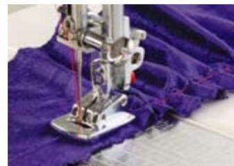
S'emploi pour froncer simplement et rapidement des bandes de tissu. La grandeur des fronces sera déterminée par le poids du tissu, la longueur des points et la tension du fil.
