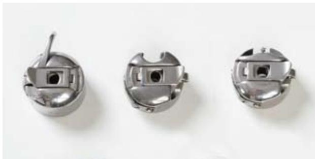
Un mécanisme avec un crochet horizontal ou vertical demande une capsule différente, qui règle en même temps la tension du fil. Quand vous voulez travailler avec des fils spéciaux et/ou des fils décoratifs plus épais, il est recommandé d'employer une autre capsule dans laquelle vous pouvez régler la tension à votre convenance sans changer votre capsule standard, qui vous procurera toujours une couture impeccable. Il y a également des capsules spéciales pour le quilting ou pour faire du stippling.
