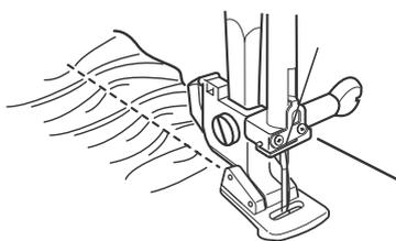
Le pied de biche a pour but de créer de petites fronces dans des tissus légers. Le dessous du pied de biche est plus haut derrière l'aiguille et à l'avant de l'ouverture de l'aiguille il devient plus épais pour réaliser des fronces uniformes. Employer plutôt un appareil à plisser si vous désirez plus de fronces ou plus grandes ou si vous voulez créer des plis.
